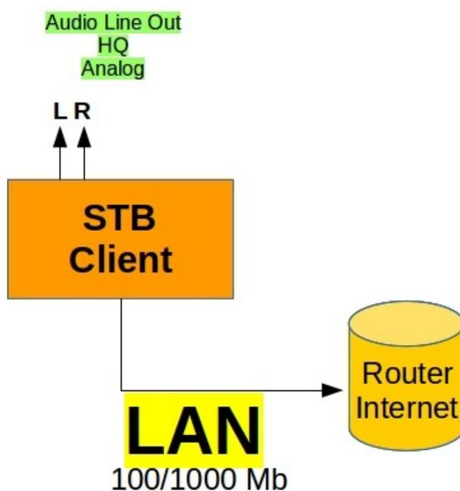
La configurazione IP del client avviene tramite protocollo DHCP tipicamente generato dal router sulla rete LAN.
